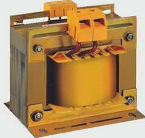
La progettazione prevede un trasformatore monofase a matello di sezione centrale quadrata, con corrente nominale massima al secondario di 48 A. Vengono utilizzati lamierini unificati al silicio con sezione centrale massima di 100 mm, induzione max 1,5 T, campo magnetizzante fino a 734,6 Asp/m, coduttori tondi con diametro massimo di 5 mm a semplice doppio e triplo isolamento.
